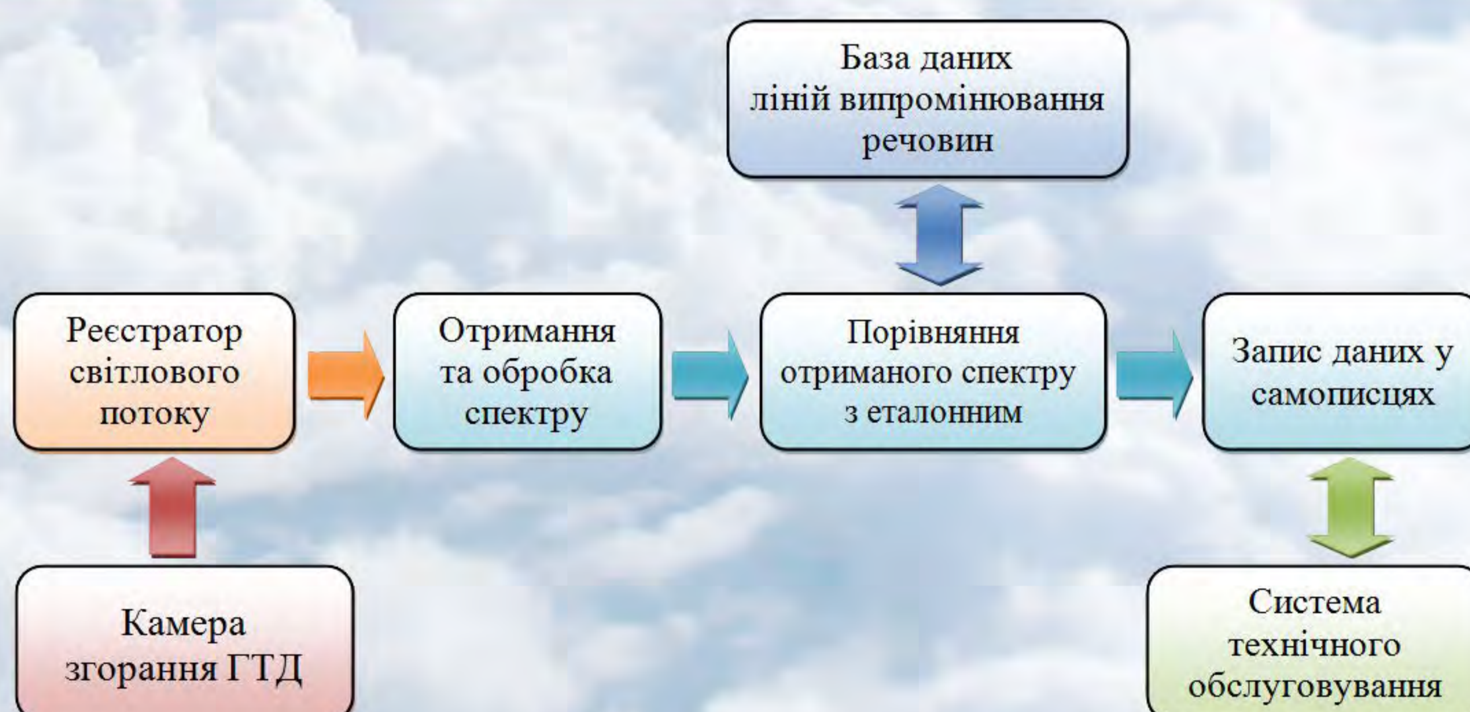
Принципова схема методу моніторингу пилового забруднення атмосфери, в якій експлуатується авіаційний ГТД
