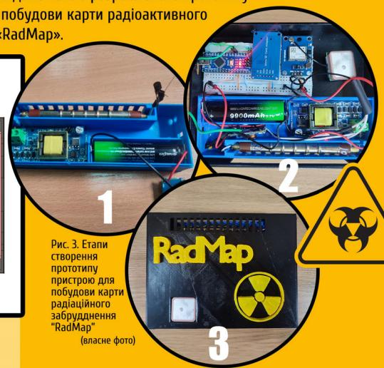
Рис. 3. Етапи створення прототипу пристрою для побудови карти радіаційного забруднення "RadMap" (власне фото)
