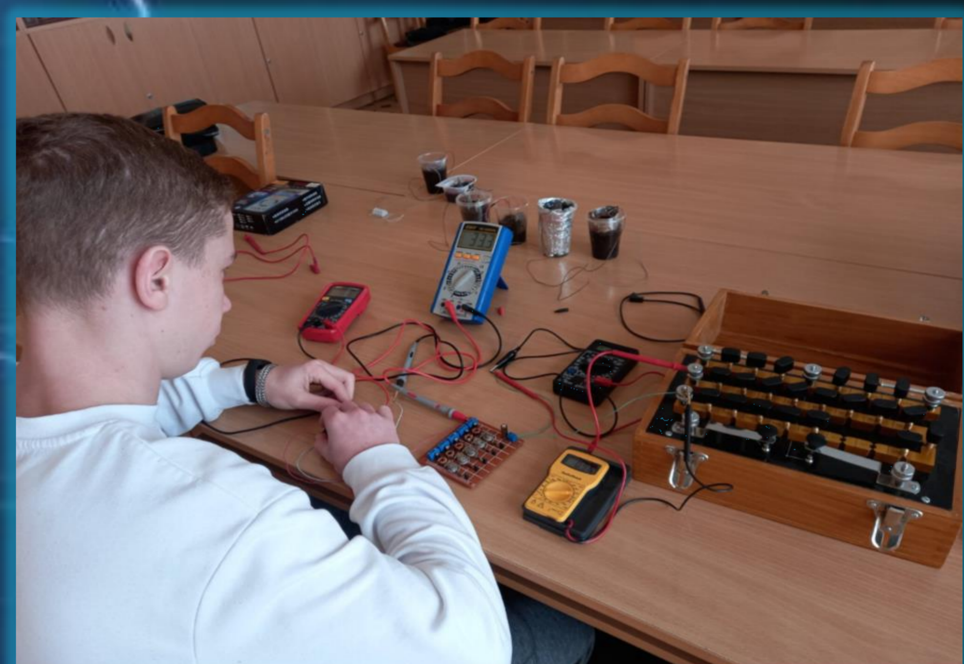
Рис.5 Проведення досліду вимірювання максимальної корисної потужності земляної батареї (фото автора)
