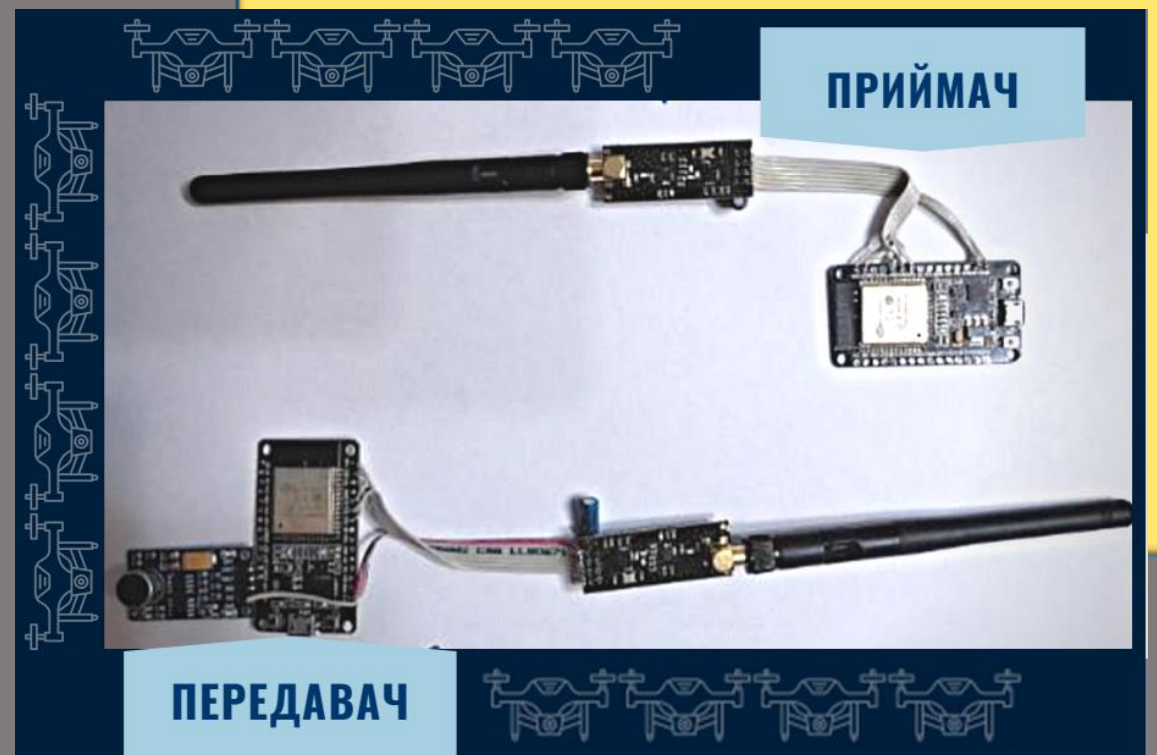
Схема підключення радіомодуля до мікроконтролера (схема автора)
