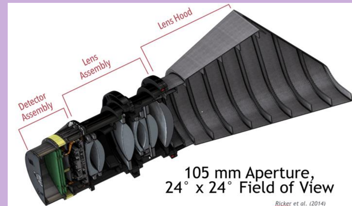
Рис. 7 Камера широкого поля зору телескопу TESS
