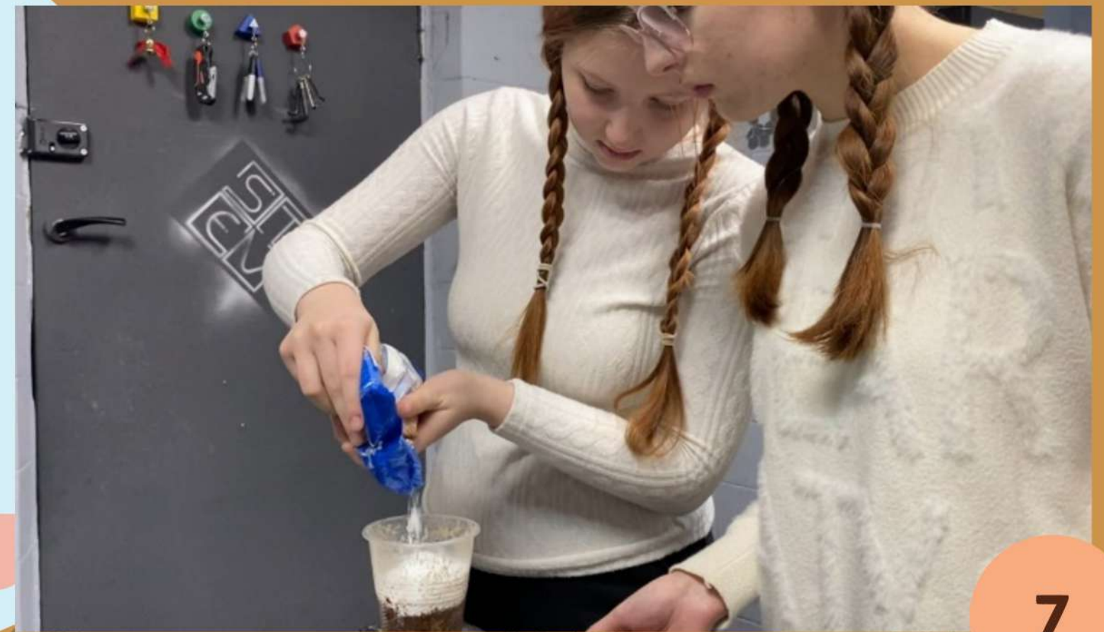
Рис. 4.,5. Підготовка і зважування компонентів для матеріалу на основі кавового жмиху (фото Новак С.В. на фото допомагає подруга Аріна)
