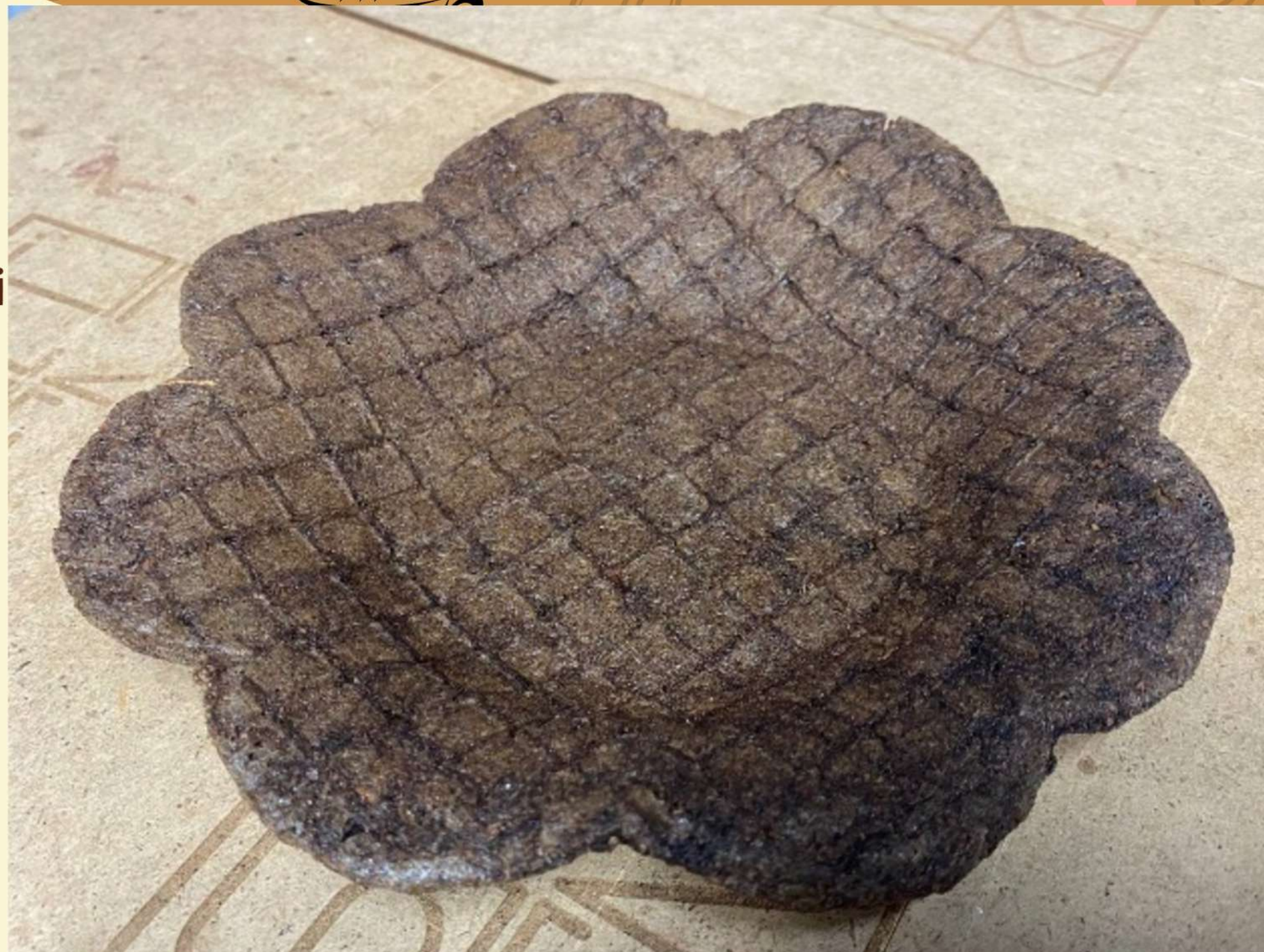
Рис. 6. Експериментальний «Зразок 4» посуду з кавового жмиху (фото автора)
