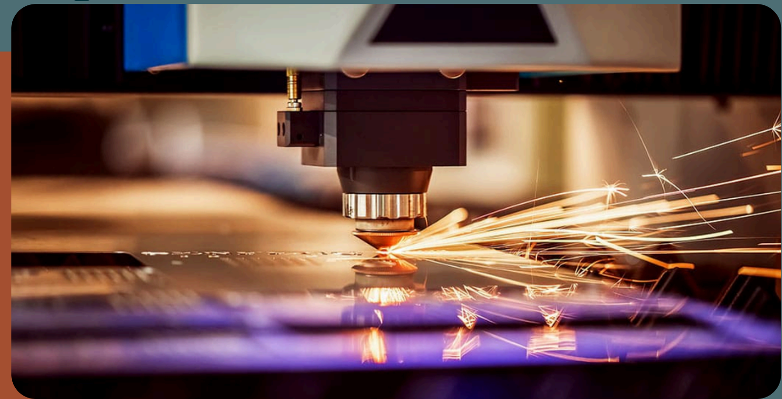
Рис. 2 Лазерна обробка матеріалу [https://www.metallurgyfordummies]
