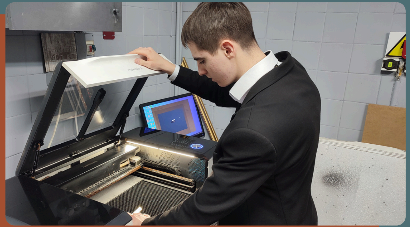
Рис. 9 Обробка зразку №1 лазерним випромінюванням (фото Денисов Д.О.)
