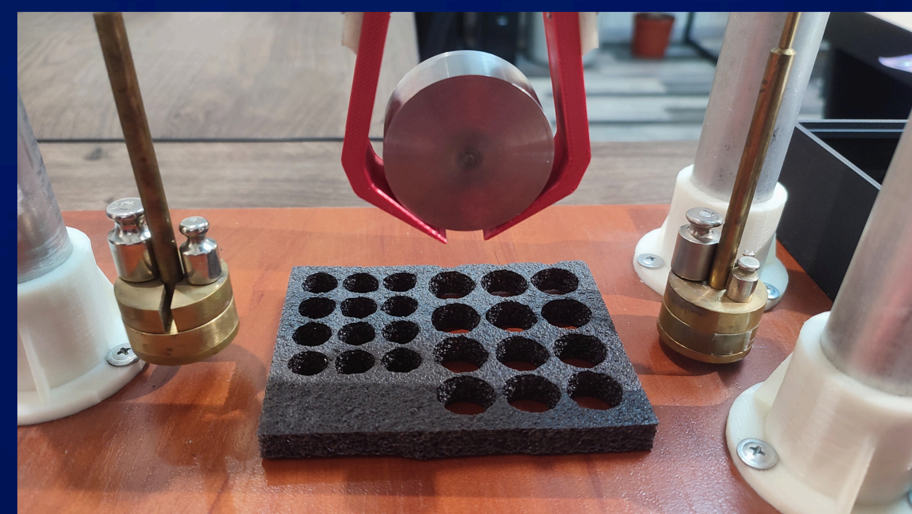
Рис.5 Експериментальне вимірювання сил затиску деталі типу «тіло обертання» захватним пристроєм з кутом призми 120° (фото автора)
