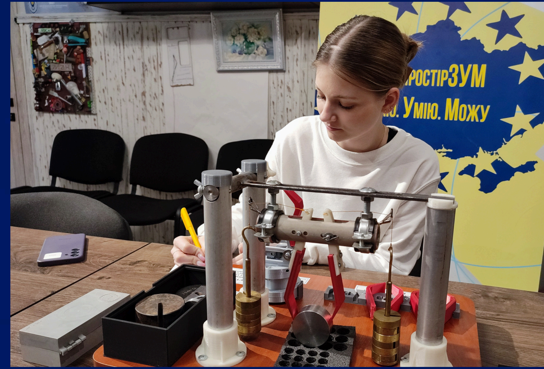
Рис.4 Робота з установкою для вимірювання сил затиску захватного пристрою робота (фото автора)
