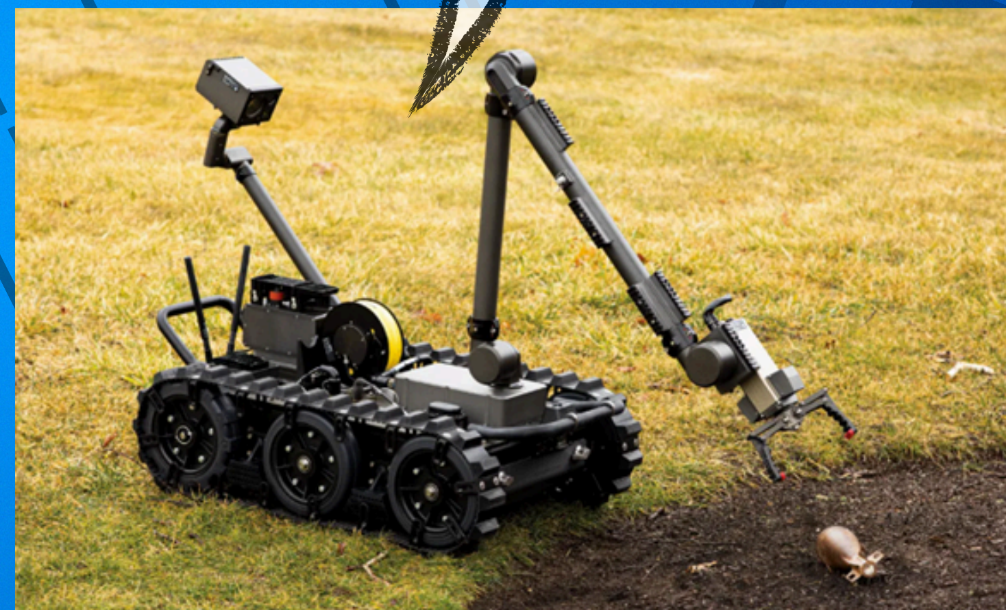
Рис. 4. Роботизована система розмінування Centaur ( https://defence-ua.com/weapon_and_tech/rjatuvatimut_zhittja_flir_postavit_600_robotiv_dlja_amerikanskih_vijskovih-3674.html )
