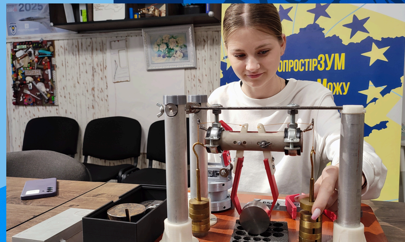
Експериментальне вимірювання сил затиску (фото Денисов Д.О.)
